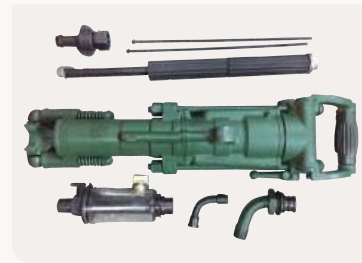
El Tabancası Rock Drill Y20 - Y24 - YT28
